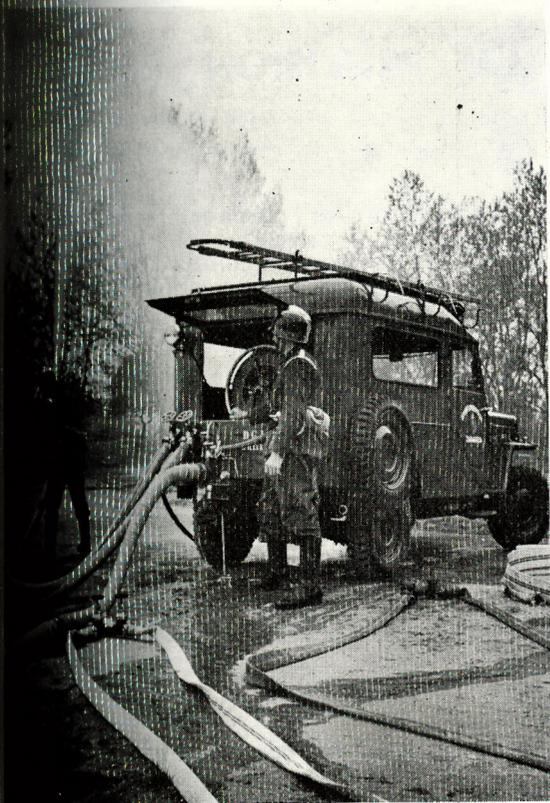
Pueden acoplarse dos mangueras de 70 mm. ó cuatro de 45 mm. a elevada presión.
